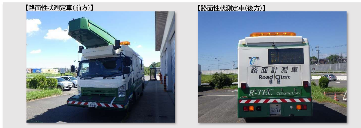
▲写真II-2-4 路面性状調査の実施状況
