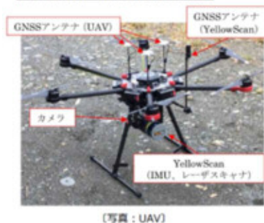
【現地作業1】レーザー搭載型UAVによる計測
